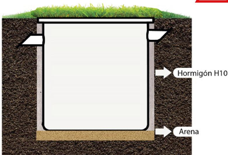
Una vez realizada la excavación colocar una cama de arena de 5 cm de espesor, bajar la cámara con las tee de entrada y salida. Luego conectar a la instalación, llenar de agua y por último calzar los espacios laterales con hormigón H10 hasta el nivel del borde superior, con un espesor mínimo de 5 cm.
